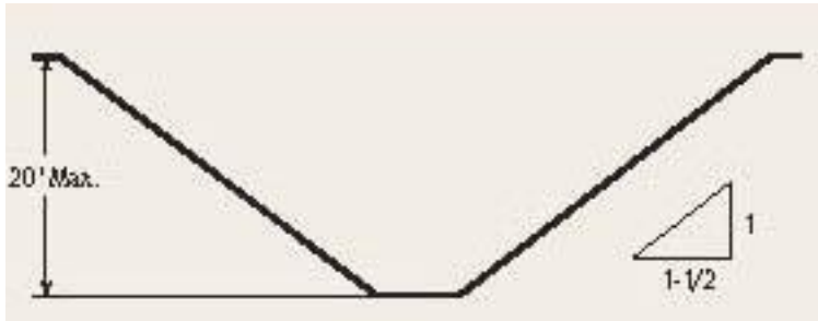
Inclinada en suelo tipo C
