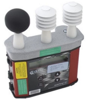
Figura 2. Ejemplo de un termómetro Wet Bulb Globe. De acuerdo con la Occupational Safety and Health Administration (OSHA), esta herramienta de predicción ha demostrado ser un indicador eficaz de estrés por calor en el cuerpo humano. (Crédito de foto: OSHA)
