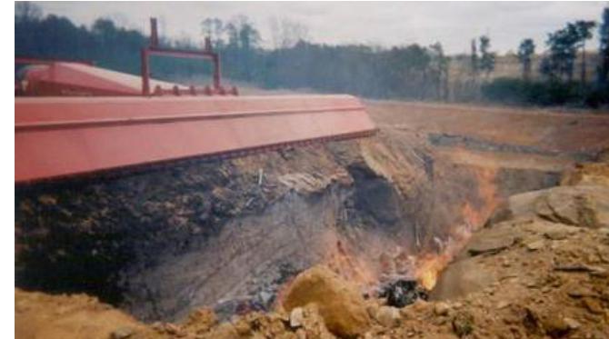
Incineración por cortina de aire
